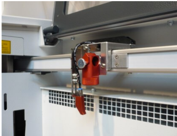
Tête du laser + Assistance d'air latérale - Speedy 100 (La Speedy 100 ne possède pas de buse)
